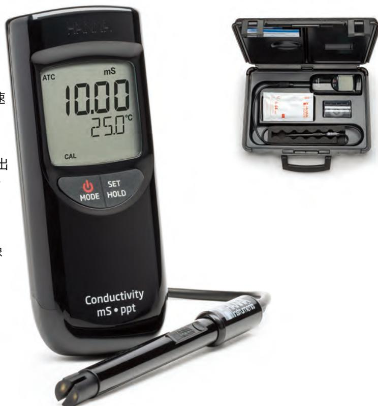
HI99300和HI99301是电导率、总溶解固体和温度计，旨在满足制造和环境测试协议中的要求。
