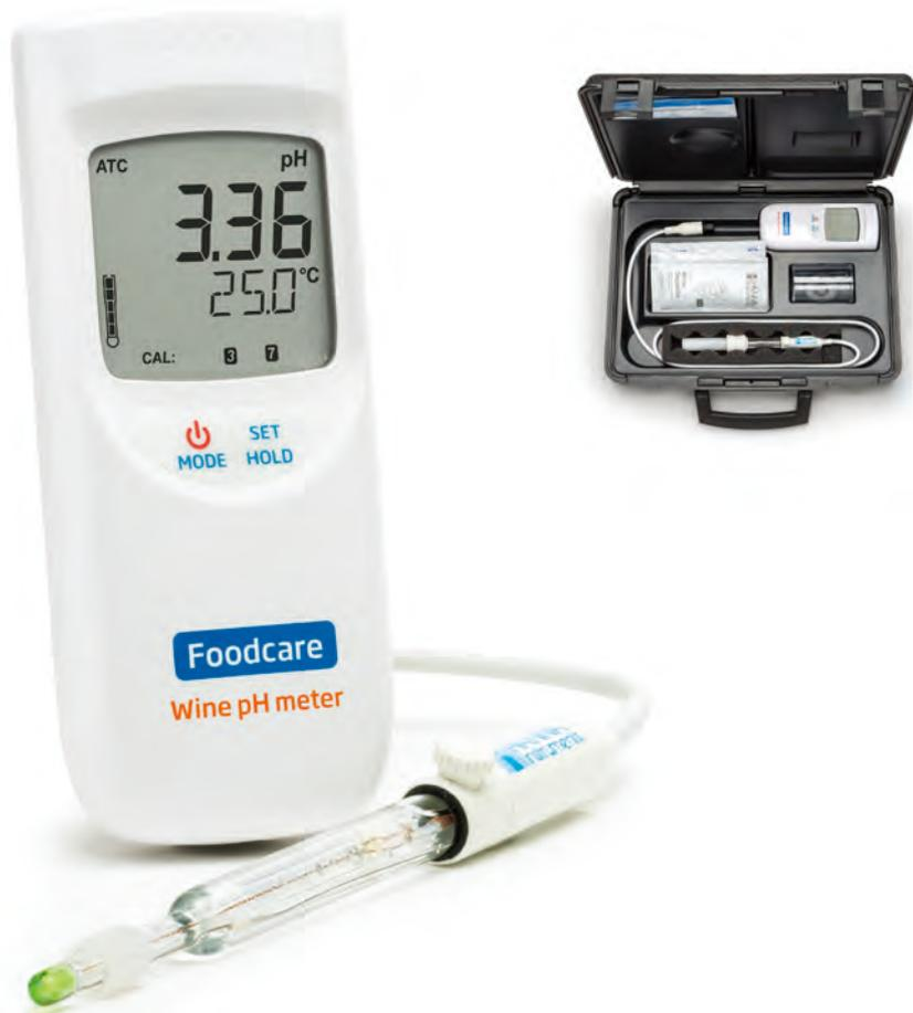
HI99111是一款基于微处理器的便携式pH和温度计。主要功能包括：扩展pH和温度范围；防水紧凑的外壳；大型双线显示器；电池电量不足检测；在两个存储的缓冲液组（标准或NIST）内的一个或两个点进行自动pH校准；可选温度单位（°C或°F）。
