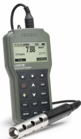
**HI98198** 采用光学荧光 (OPDP) 测量方法, 以确溶解氧测量的准确性, 通过内置标准方法和标准, 可以轻松测量溶解氧 DO、生化耗氧量BOD、耗氧速率OUR、比耗氧速率SOUR, 无需进行复杂计算。
